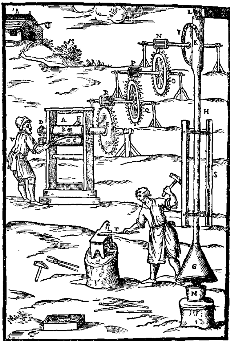
Рис. 2. Проект установки, использующей горячие газы кузнечного горна для вращения огненного колеса (I), приводящего в движение, при помощи системы зубчатых передач, валцы для чеканки монет из золота, серебра, меди.
